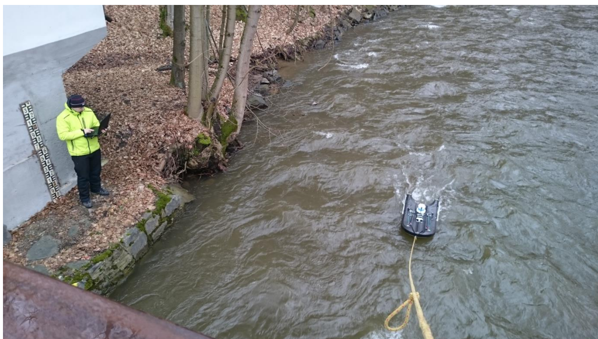
Obr. 2 Měření přístrojem ADCP SonTek RiverSurveyor M9 na profilu Březná / Hoštejn.
