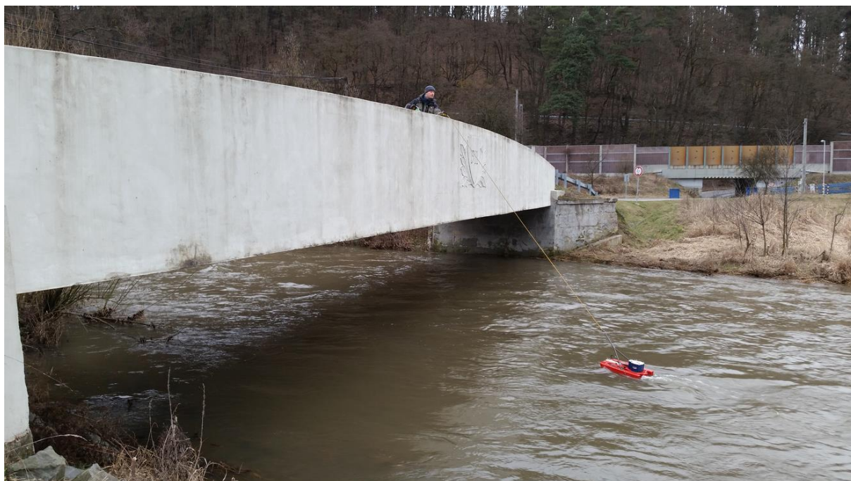
Obr. 1 Měření ADCP přístrojem RDI StreamPro na profilu Moravská Sázava / Lupěné.
